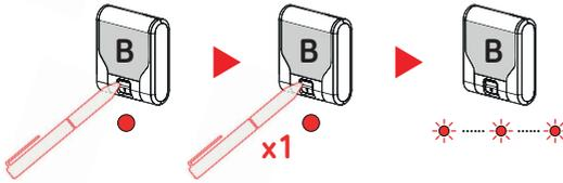
Effectuez **1 appui connect** sur le récepteur à ajouter au réseau, il va alors clignoter lentement, indiquant qu'il recherche le réseau.
