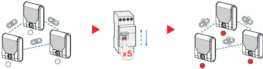
Effectuez **5 coupures** de courant au tableau, en prenant soin d'attendre environ **2 secondes** entre chaque coupure. Les récepteurs confirment qu'ils **n'appartiennent plus à un réseau** par une **LED rouge fixe**.
