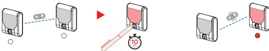
1/ Effectuez un **appui connect long de 10 secondes** sur le récepteur que vous souhaitez supprimer du réseau.
