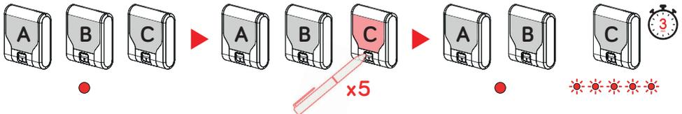
Effectuez **5 appuis connect rapides** sur un récepteur pour créer le réseau, ce même récepteur va alors clignoter rapidement, indiquant qu'il se met en écoute pendant 3 minutes.
